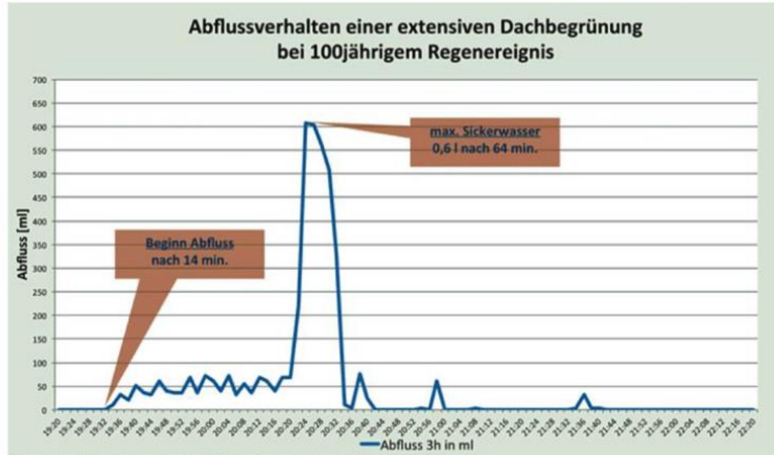
Sickerwasserabfluss einer extensiven Dachbegrünung bei einem 100-jährigem Regenereignis (Extensive Dachbegrünung = Schichtstärke des durchwurzelbaren Substrates liegt bei 10 - 15 cm)
